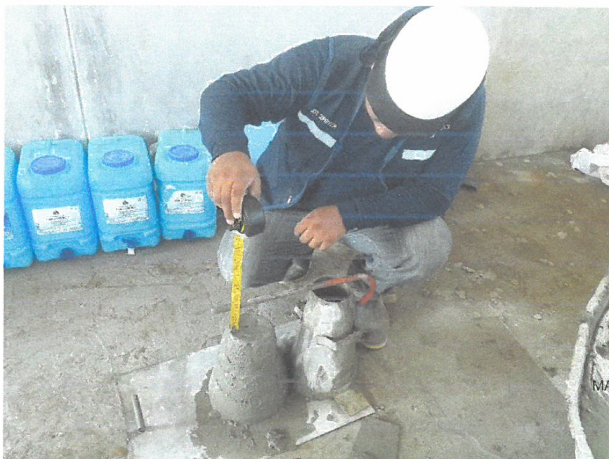
Foto N° 10: Vista del ensayo Slump del concreto en la obra "Mejoramiento y Equipamiento del servicio Educativo N 62200 Barrio Carabanchel - San Lorenzo, Distrito Barranca, Provincia Datem Del Marañón - Loreto"
